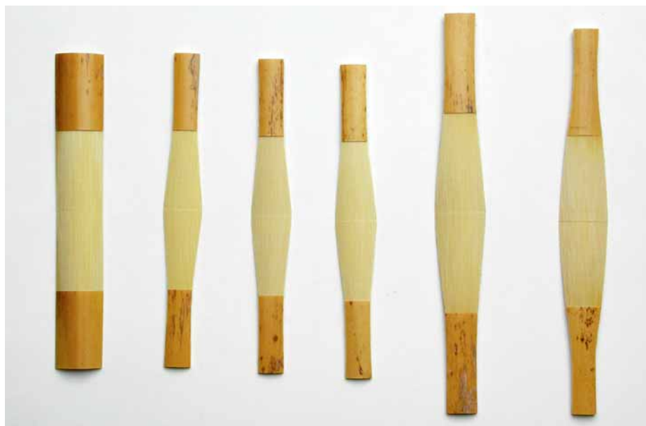
Fassionierte Hölzer. Ganz links ein sogenanntes innen und außen bearbeitetes (gehobeltes) Holz; daneben gleiches Holz, aber fassoniert. Zweite Abbildung von rechts: fassoniertes Kontrafagottholz und ganz rechts fassoniertes Barockfagottholz.
