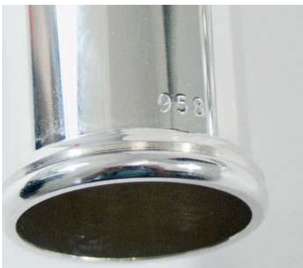
Der Prägestempel verrät, wie hochwertig das Material ist. 958 steht für den Feinheitsgrad des Britannia-Silbers in Tausendsteln.
