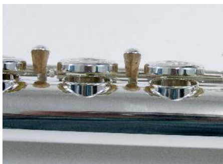
Naturkork ist ein hochwertiges Material für die großen Korpusdämpfer.
