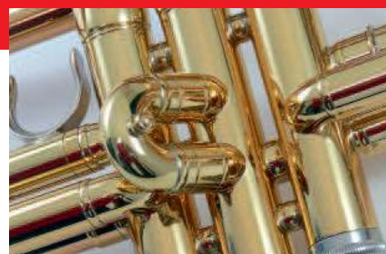
Neuerung 3: Alle Züge sind nun mehrteilig und verlötet. So können beispielsweise Reparaturen besser ausgeführt werden.
