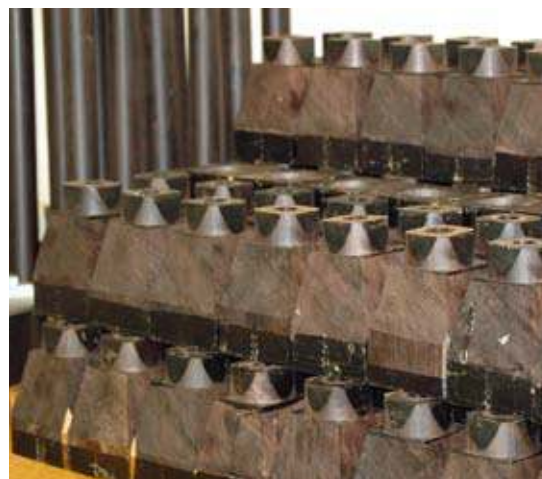
Etwa zehn Jahre wird das Grenadill-Holz gelagert. So vermeidet man, dass sich das Holz später verzieht oder sogar reißt.
