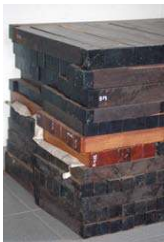
Etwa zehn Jahre wird das Grenadill-Holz gelagert. So vermeidet man, dass sich das Holz später verzieht oder sogar reißt.
