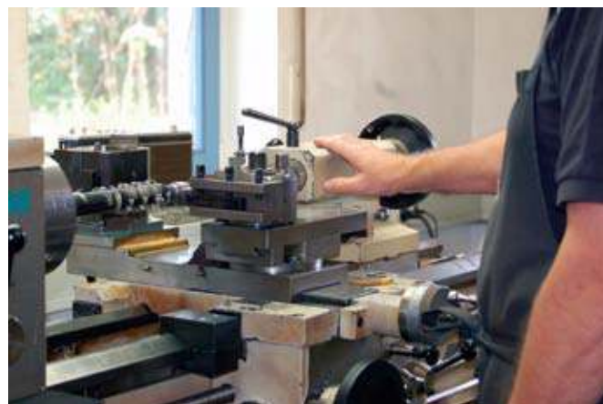
An der Drehmaschine wird der Zapfen, der die einzelnen Teile der Klarinette miteinander verbindet, angedreht.
